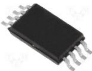
**SE95** – высокоточный цифровой датчик температуры, объединяет на одном кристалле чувствительный элемент, 13-ти битный сигма-дельта АЦП (обеспечивает резолуцию 0,03125 °C), регистр конфигурации, измеренной температуры, пороговой температуры, гистерезиса, pin-to-pin совместим с индустриальным стандартом LM75/LM75A.
